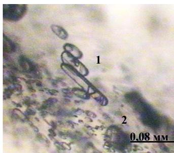
*Рисунок 3. Многочисленные флюидные(1) и минеральные (2) включения в корунде.*
