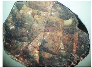
Рисунок 3. Фрагмент метеорита Брагин. Светлые зерна – оливин. Размер образца 1см.
