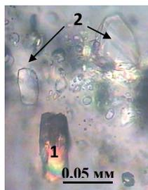
Рисунок 5. Включения магнетита (1) и кальцита (2) в корунде.
