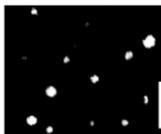
Гелиевые кластеры («пузырьки») размером 5-10 нм в алюминии. Фотография получена с помощью трансмиссионного электронного микроскопа.
