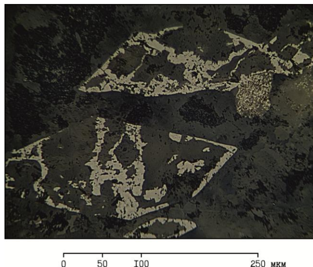
Рис. 55. Рутил-кварц-карбонатные псевдоморфозы по титаниту, феррокарбонатит. Отраженный свет, при одном никеле.
